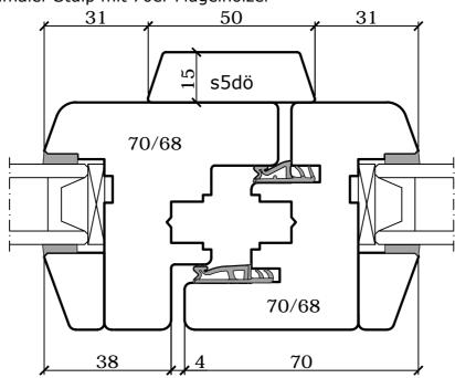
Horizontalschnitt Stulp mit Schlagleistengetriebe
