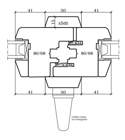
Horizontalschnitt Setzholz mit 2 Flügeln
