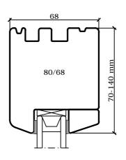
Ausführungsvariante mit Regenschienenverglasung (im Elementbau Standard)
