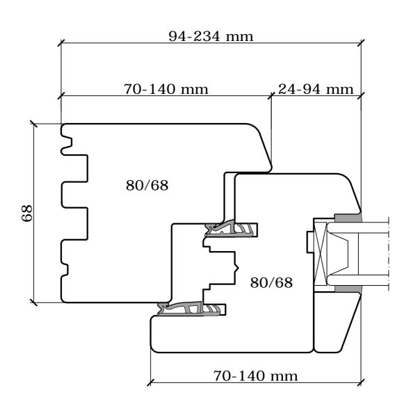
Horizontalschnitt Schlossseite bei abschliessbarem Getriebe / BTV
