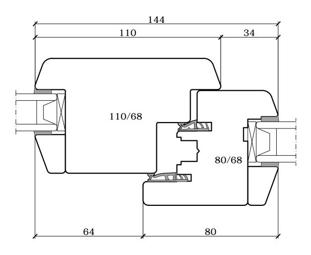
Vertikalschnitt Kämpfer mit 2 Flügeln
