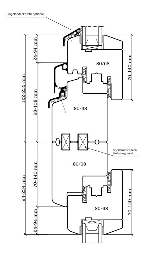
Vertikalschnitt Balkontüre unterer Anschluss Türe mit Einleger
