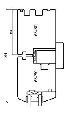
Nur mit einfacher Dichtung möglich und in Holz 68
