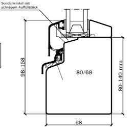
Ausführungsvariante als Blendrahmenverglasung, nur mit Aussenbankfalz möglich. (wegen Glasfalzentlüftung)
