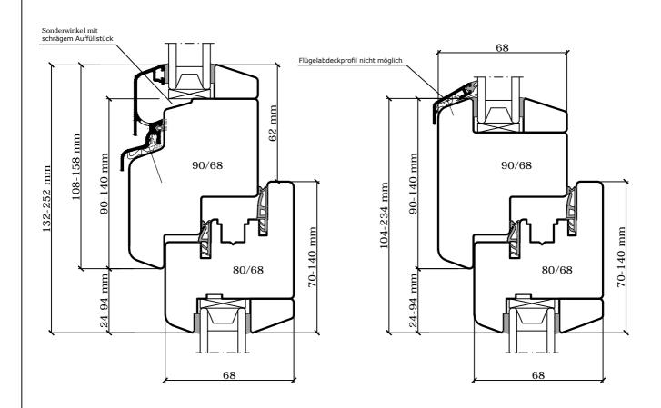
Vertikalschnitt Kämpfer mit Festverglasung unten und einem Flügel oben
