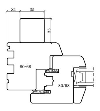
Rolloleiste verdeckt Nr. 2 ohne Nut Lieferung lose oder montiert
