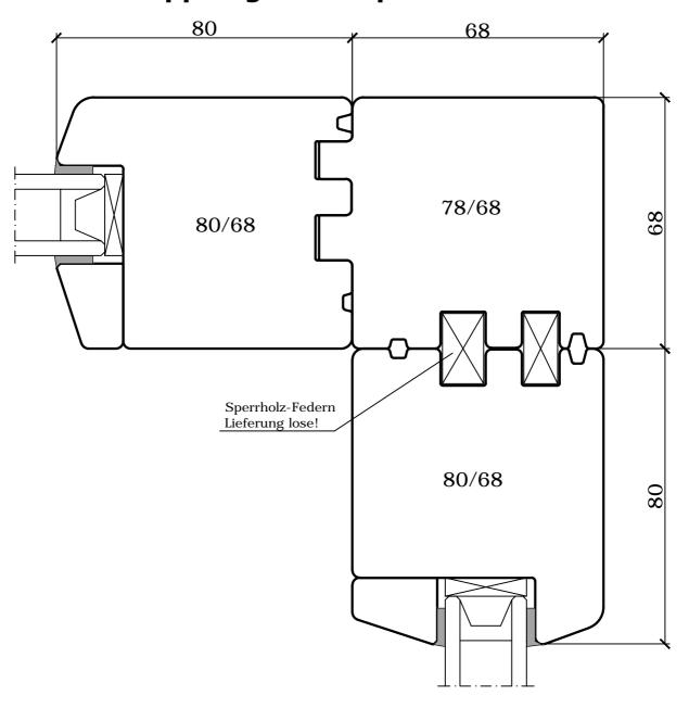
Horizontalschnitt Eckkopplung 135° mit zwei Festverglasungen über Gehrung
