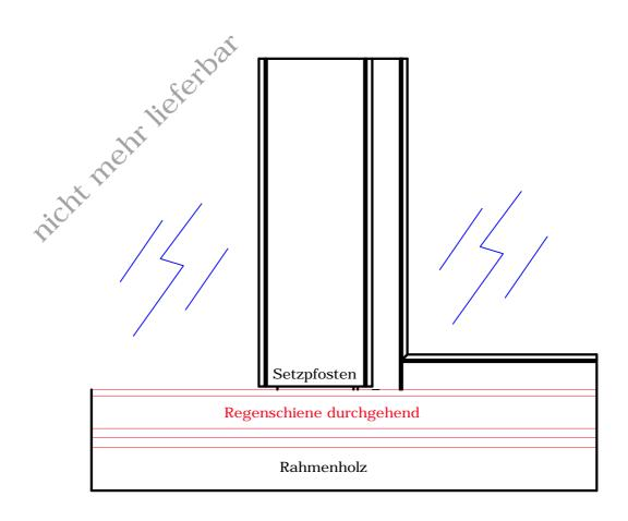
alte Regenschiene durchlaufend Setzpfosten unten ausgeklinkt nicht mehr lieferbar
