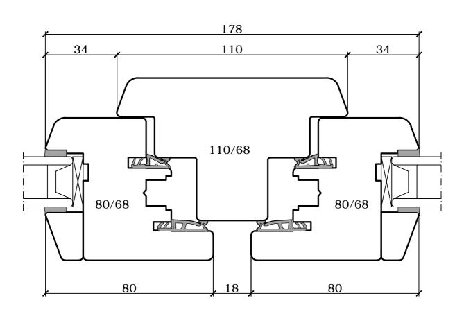
Horizontalschnitt Setzholz mit Festverglasung und einem Flügel
